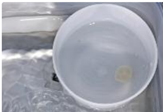
Eliminar los residuos con ultrasonido en un baño de agua
