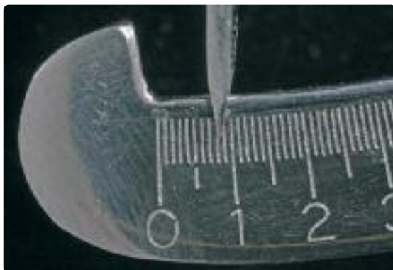
Hay que asegurarse que los grosores mínimos se conservan incluso después del repasado.
